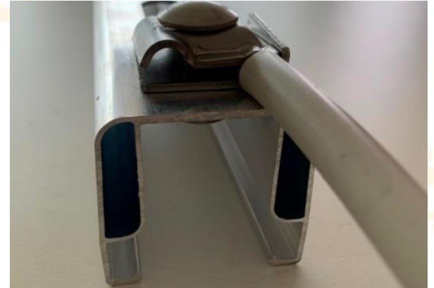
Insérez le câble de terre dénudé dans le connecteur
